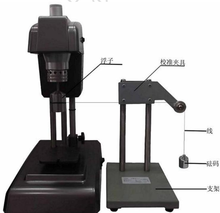
图（七）静负载校准装置
